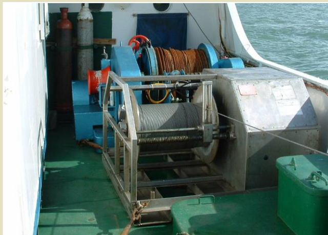
Treuil : remonté du poisson max. 1 m/s
