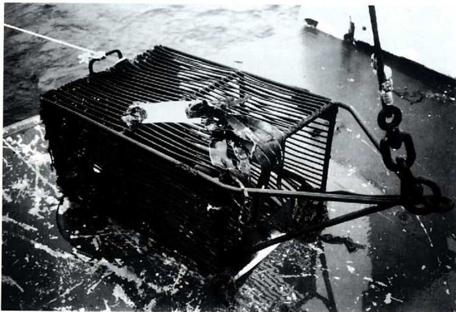
Fig. 4 - Drague à palourdes d'ouverture 0,60 m et de maillage 15 mm
